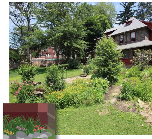
Esta depresión poco profunda y con plantas absorbe el agua que fluye de un techo o patio.
